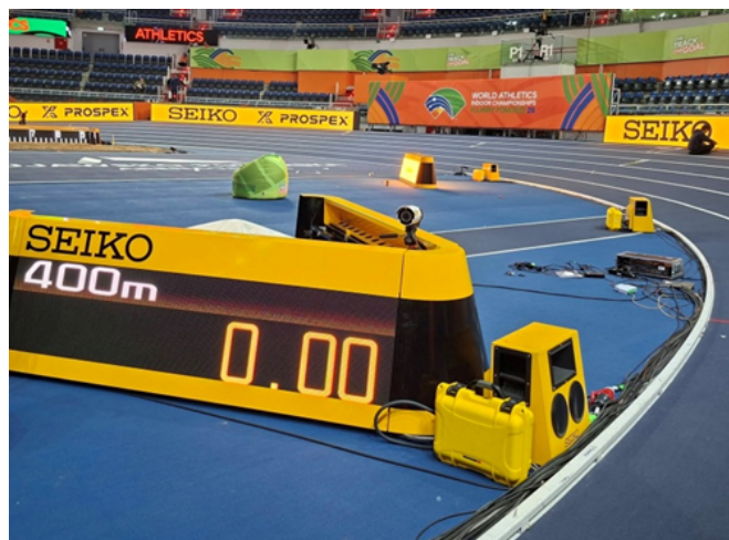
Jedna z kamer pomiarowych Vision PRO X, po lewej usytuowanie kamerki bocznej, fot. Kinga Szczęch
